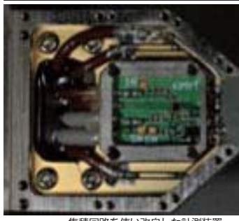
集積回路を使い改良した計測装置。先端の針で雑音を感知する
